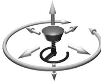
Abbildung 1: Das ChairIO als Spiele Device mit einem zusätzlichen Handeingabegerät. Rechts sind die Bewegungs- und damit Steuermöglichkeiten des ChairIO's dargestellt. Hier wird der Swopper™ from aeris-Impulsmöbel GmbH als Basisstuhl des ChairIO eingesetzt.
