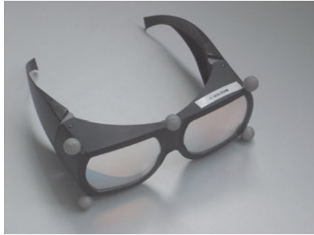
Abbildung 5: Infitec-Filterbrille mit reflektierenden Kugeln als Trackingziele
