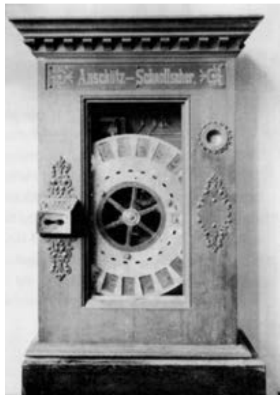
Anschütz' Elektrischer Schnellseher, hergestellt von Siemens & Halske (1891)
