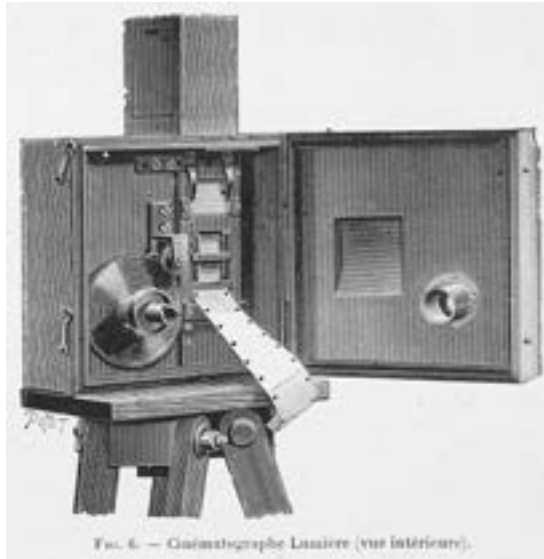
Cinématographe Lumière (1895), Film eingelegt zur Aufnahme
