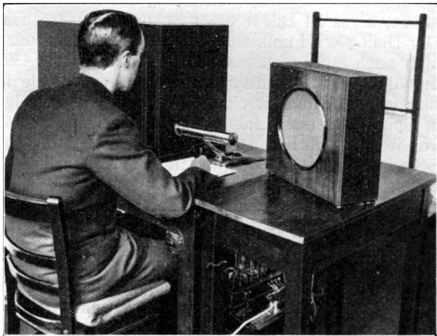
Abb. 1: Topoly-Messmaschine zum Ausmessen der fremdsprachigen Originalfassung für Nachsynchronisation bei Nadelton (aus: Umbehr, Heinz/Wollenberg, Hans: Der Tonfilm. 2. Auflage 1932, S. 419.)
