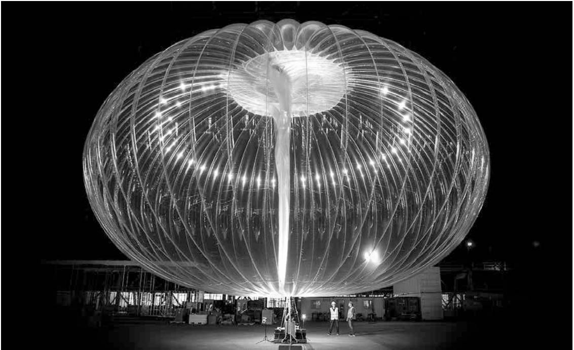
Abb. 3 Entfalteter Loon im Test
