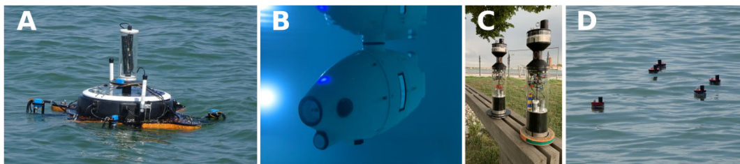
Abbildung 4: Die drei Typen von Robotern im subCULTron Schwarm. A) aPad , B) aFish , C,D) aMussel
