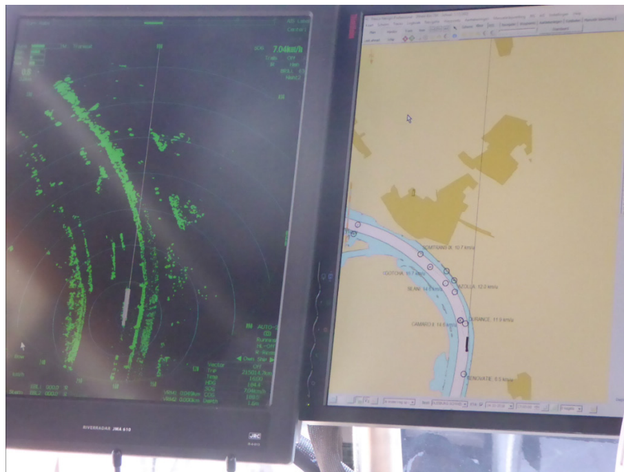
Abb. 1: Zwei Monitore im Steuerhaus eines großen Schubbootes (das sechs Schubleichter schiebt). Links ist das Radar, rechts eine nautische Karte, die mit AIS überlagert ist. In der oberen rechten Ecke ist außerdem die aktuelle Geschwindigkeit von 12,4 Kilometern pro Stunde
