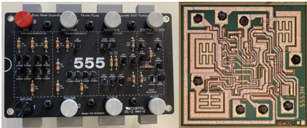
Abb. 7: Diskreter Nachbau des NE555 (links, eigenes Foto), Fotografie eines NE555 78 (rechts).
