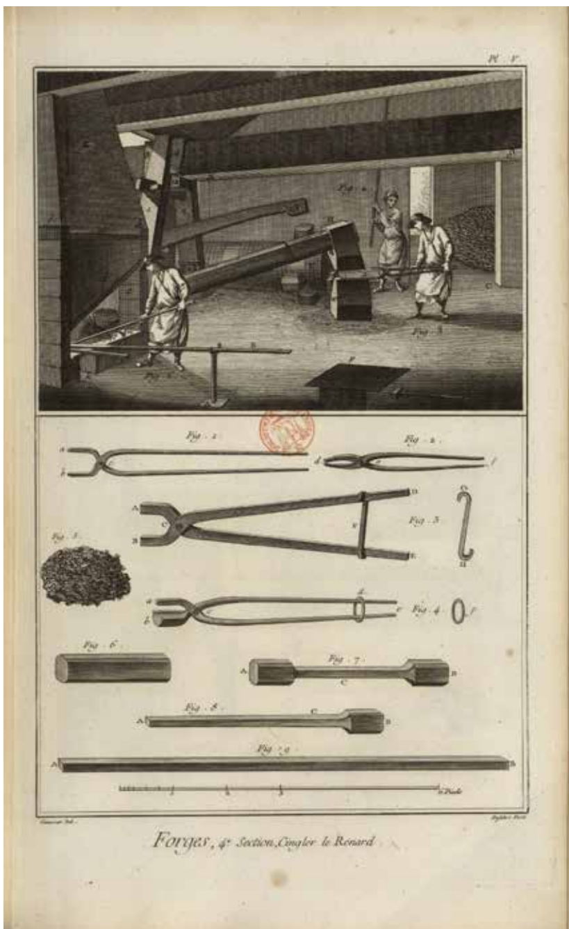
"Forges. 4 th Section. Rolling muddled iron." Encyclopédie, ou dictionnaire raisonné des sciences, des arts et des métiers (Paris, 1751–1772). http://enccre.academie-sciences.fr/encyclopedie/ .
