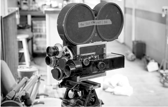
Abb. 83: Eine Bell & Howell 2709 35-mm-Filmkamera aus dem Jahr 1922 mit doppeltem Filmmagazin, Objektivrevolver und seitlichem Sucher, fotografiert 2012 von Adam J. Wilt. Quelle: adamwilt.com.
