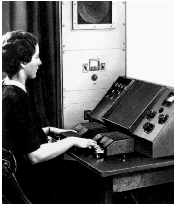
Abb. 3 Voder (Voice Operating DEMonstratoR) der Bell Labs, erstmals auf der Weltausstellung 1939 präsentiert, Foto 0.J.
