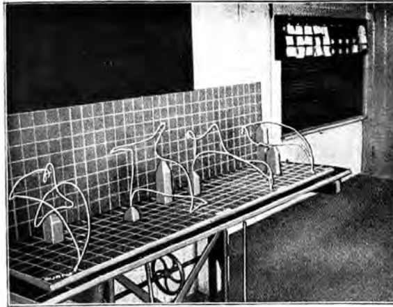
Abb. 9. Drahtmodelle, die den Fortschritt in der Erlernung des besten Arbeitsverfahrens zeigen. Die Drähte zeigen den Weg der linken Hand an der Bohrmaschine. Es handelt sich in diesem Falle um den Leiter eines Betriebes, der seit 25 Jahren die betreffende Maschine nicht angerührt hatte.
