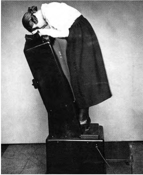
7 – Pedoskop – Röntgenerät zur Überprüfung der Passform von Schuhen
