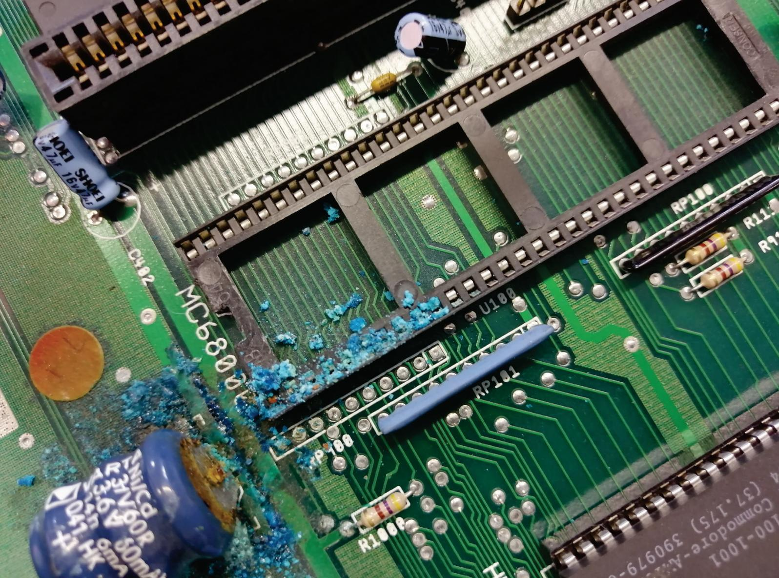
Oben: Auslaufende Batterie auf der Hauptplatine eines Computers.
