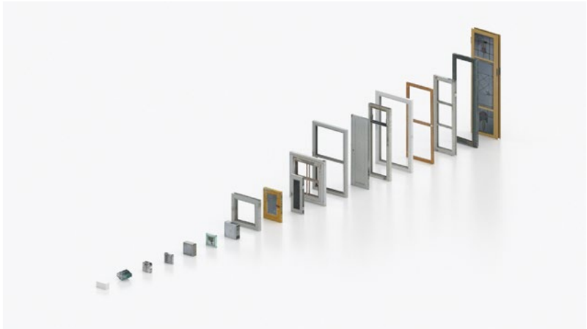
Abbildung 5: Digitaler Baukasten: Die 3D-gescannten Fenster der Bauteilbörse Hannover. Neben den Dimensionen und der Gestalt, können weitere Attribute wie verfügbare Anzahl oder Kosten hinterlegt werden, Hochschule Hannover / André Nakonz
